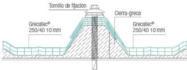
Detalle de fijación en solera Greca® 250/40 10 mm
